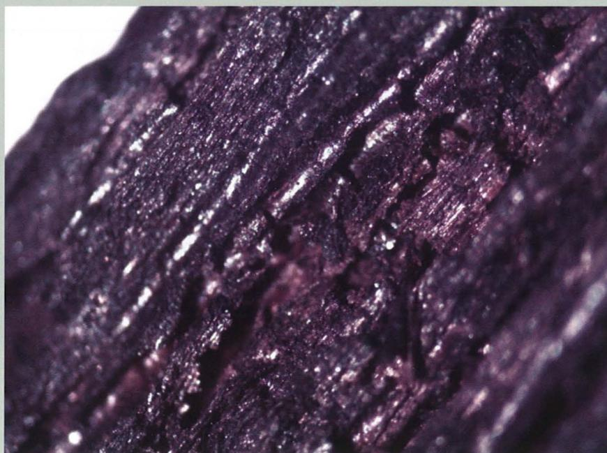
Figure 1. Photos de biochar fait de sciure de bois mou par la technologie Airex Energie
